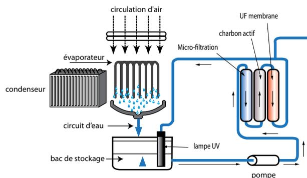
**LE FONCTIONNEMENT :** L'air est aspiré, puis passe devant un évaporateur. L'eau contenue dans l'air sous forme de vapeur est transformée en gouttelettes. Ces gouttelettes se déposent sur l'évaporateur et sont récupérées dans un réservoir. Ensuite, cette eau est traitée pour en faire une eau potable exceptionnelle.
